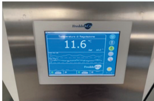
Испытательная климатическая камера состоит из испытательной камеры для имитации комнатной температуры и холодной камеры для моделирования температуры наружного воздуха.
