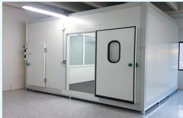
Испытательная климатическая камера состоит из испытательной камеры для имитации комнатной температуры и холодной камеры для моделирования температуры наружного воздуха.
