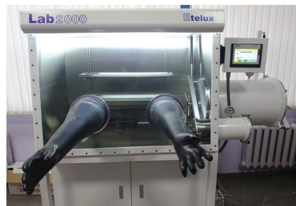
Рис. 2. Перчаточный бокс, введенный в эксплуатацию в ноябре 2022 в рамках организации участка исследований
