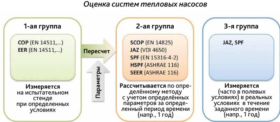
с серией директив VDI 4650). Обычно берутся в расчет температура в определенные моменты эксплуатации насоса, подаваемый энергоноситель, и все это рассчитывается на период в течение года. Получаем суммарный годовой показатель энергоэффективности работы теплового насоса. Рассчитывается по определенному методу с учетом определенных параметров за определенный период времени.
